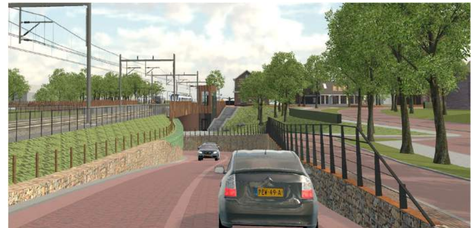
Wand ten noorden van rijbaan is lager dan maaiveld/spoorhoogte, met groen bekleed
